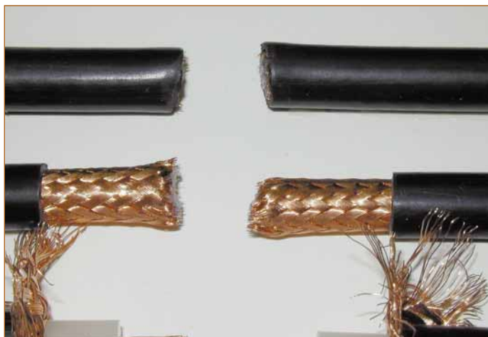
FIGURA NÚMERO DOS: CUBIERTA RETIRADA.
