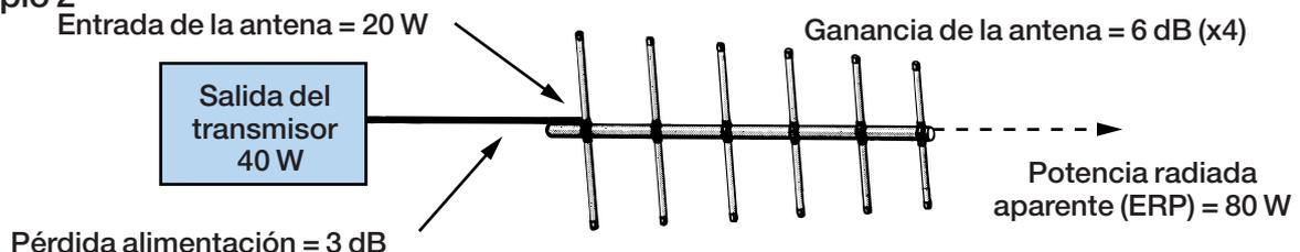
Debido a la pérdida de alimentador, sólo la mitad de la potencia que sale del transmisor llega a la entrada de la antena (20W). Esta antena tiene una ganancia de 6 dB (x4) por lo que, la potencia radiada aparente será de 80 W (en la dirección de máxima radiación)
