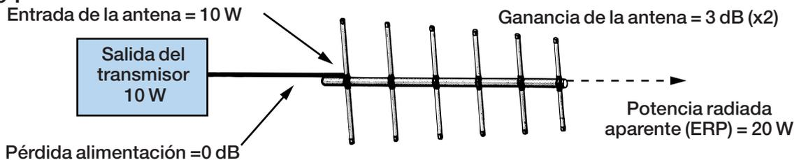
Toda la potencia que sale del transmisor llega a la entrada de la antena (10W). Esta antena tiene una ganancia de 3 dB (x2) por lo que, la potencia radiada aparente será de 20 W (en la dirección de máxima radiación)
