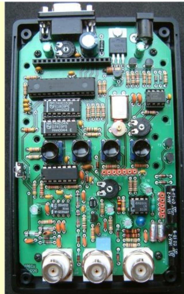
Placa de circuito impreso a doble cara, serigrafiada, acabado profesional y libre de plomo conforme a las normas RoHS, al lado tenemos la placa con todos los componentes montados excepto el display LCD que se ha retirado para poder ver los componentes que están debajo de él.
