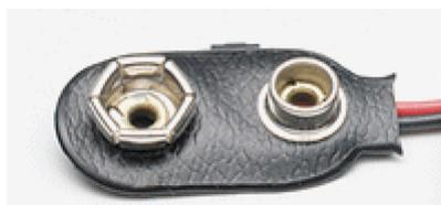
Es necesario un simple conector de 9 voltios, **pero recuerde que debe invertir la polaridad (el agujero “grande” es el positivo pero debe ser conectado al polo negativo del Circuito Zener) para hacer como si fuera una pila.** Hay un conector similar en el MFJ-299, por lo que los dos conectores encajaran perfectamente.
