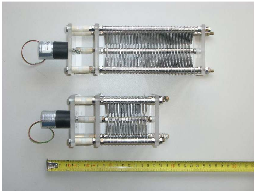
Comparativa dimensional de los condensadores de 130pF y 65pF.
