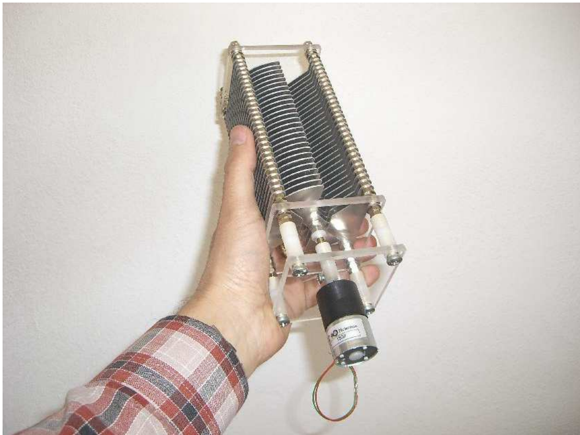
Condensador de 130pF
