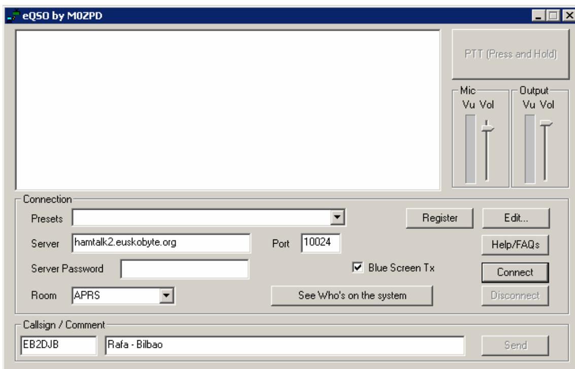
El software, utiliza la tarjeta de sonido que tengamos definida por defecto en Windows. Podemos regular el nivel de micro y de altavoces a la derecha. Para ajustar el nivel de micro, es obligatorio estar conectado a un servidor. Si no, no marca el VU-meter.
