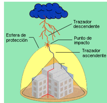
Figura 4 Pararrayo con sistema de cebado
