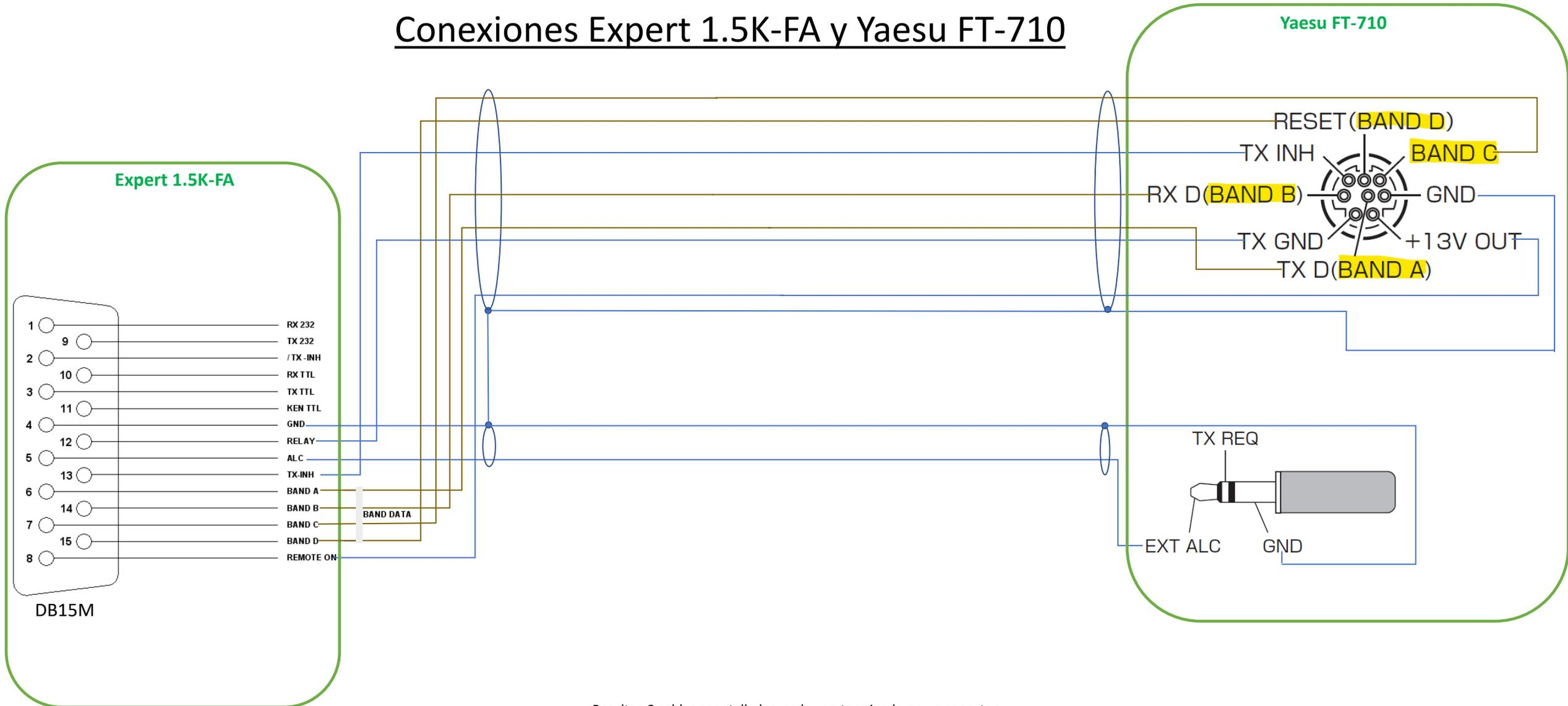
Resultan 2 cables apantallados, cada uno terminado en un conector distinto hacia la radio (y saliendo los 2 del conector CAT del amplificador)
