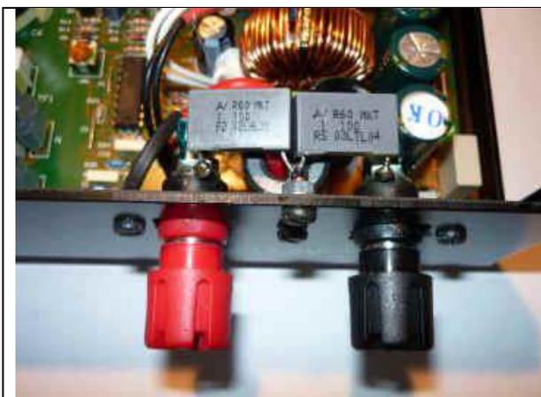
Se instalaron nuevos conectores de salida y se instalaron nuevos capacitores de derivación de 1 uF y 100 V.
