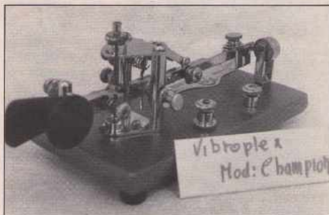
Figura 1. Perspectiva del manipulador semiautomático de la marca Vibroplex, modelo Champion, visto desde su ángulo inferior de la derecha. Los bornes de conexión, el amortiguador G, la pesa deslizable y los ajustes F y D (figura 3) quedan en primer plano.
