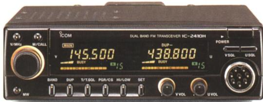
Transceptor de doble banda en VHF y UHF, FM, para aplicaciones tipo fijo o móvil. Los indicadores de frecuencia y de función son de gran tamaño para facilitar su interpretación. Puede ser fácilmente ubicado en vehículos o estaciones de trabajo debido a su reducido tamaño.
